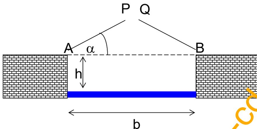
Über einen Fluss mit der Breite  $b = 13$  m führt eine Zugbrücke. Das Gelenk  $A$  der Brücke liegt  $h = 3,7$  m über dem Wasserspiegel. Die Brücke lässt sich höchstens so weit öffnen, dass die beiden Brückenhälften unter dem Winkel  $\alpha = 31^\circ$  gegen die Horizontale geneigt sind.
